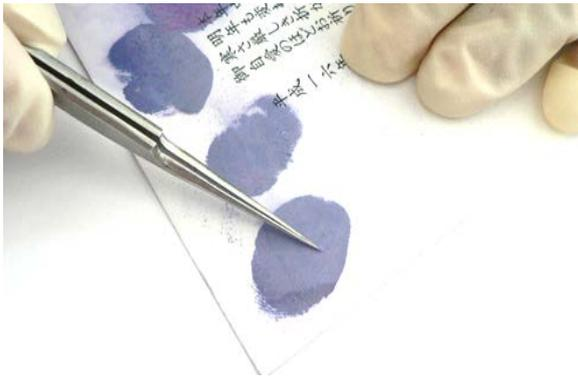
インクジェット用はがきからの採取では、粘着テープの粘着剤が剥がれて採取できません。（洗浄したピンセットや金属製の板などを用いて、表面を引っ掻き資料を採取し易くします。）
