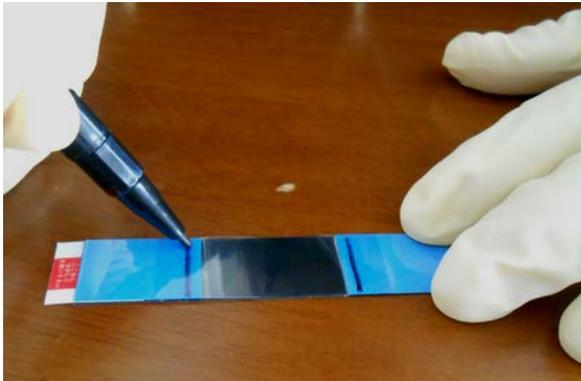
微物トレールの透明保護シートの両脇に、マジックで線を引く。(採取番号を表示する。)
