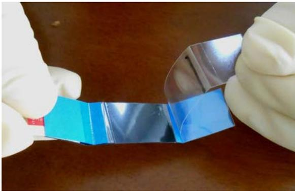
微物トレールの透明保護シートだけを剥がす。(中央の採取部位に触れないように注意する。)
