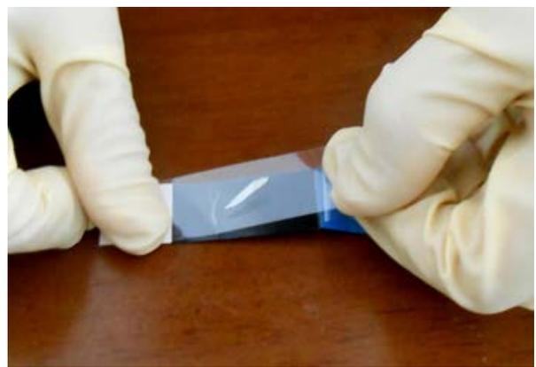
塗膜片を採取した透明保護シートの端を、剥離シートの端に合わせて貼り付ける。
